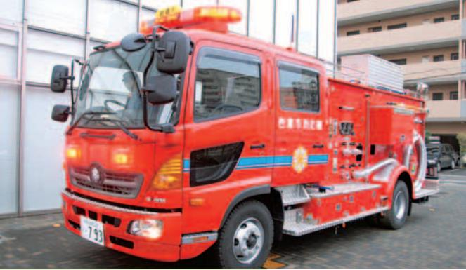
▲12月19日(木)、化学消防ポンプ自動車が消防署に配備されました。この車両は、圧縮空気泡吐出装置により、少量の水で効率の良い泡消火をすることができます。
