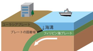
海側のフィリピン海プレートが毎年数cmの速度で陸側のユーラシアプレートの下方に沈み込む。
