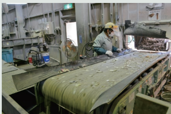
人の手や機械により、びん以外の異物がないか、別の色が混ざっていないか等を選別します。
