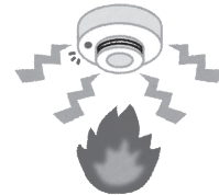
◀自動火災報知設備
