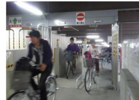
図 ICタグゲートシステムを採用した市営南草津駅自転車駐車場（資料：草津市）
