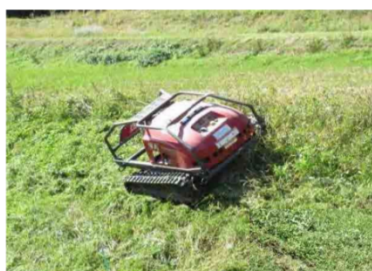
作動中のラジコン草刈機
